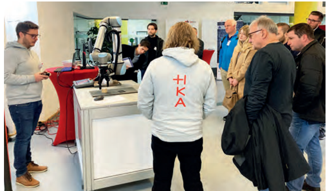
Prof. Björn Hein demonstriert an einer Greifaufgabe, wie Roboter durch Vormachen programmiert werden können. Fachwissen zu speziellen Programmiersprachen muss somit nicht mehr im Unternehmen vorhanden sein oder eingekauft werden, um Prozesse mittels Robotik zu automatisieren.
