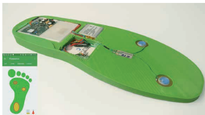
Autonomer Fußsohlensensorprototyp mit thermischem und kinetischem Harvester, hergestellt im Rahmen einer Bachelorarbeit an der HsKA und der B&W Embedded Solutions GmbH Foto: Joseph Pal
