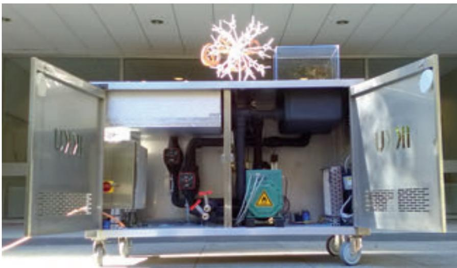
Blick in das Innere des BFB auf die Hochtemperaturwärmepumpe
