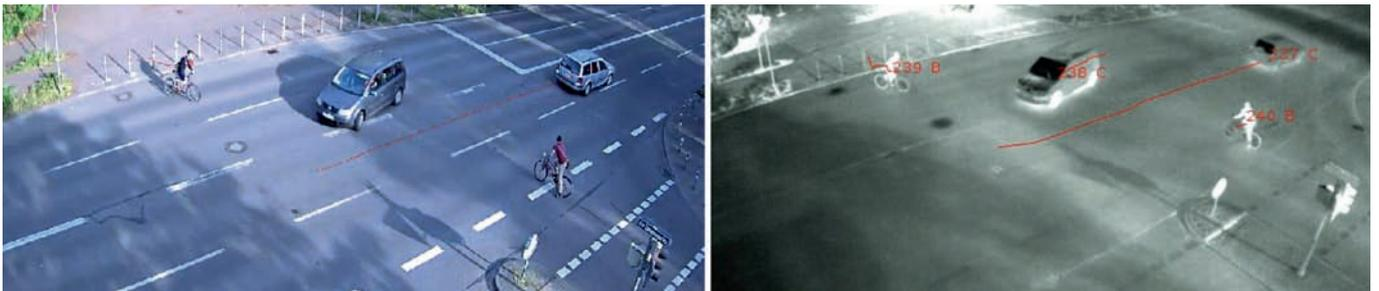
Vergleich der Bildausgabe: links Netzwerkkamera, rechts Wärmebildkamera
