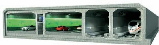
Querschnitt des Senkkastentunnels,
