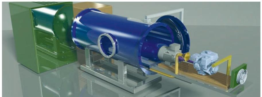
CAD-Konzept einer mobilen Klimakammer mit ausfahrbarem Teleskoptisch
