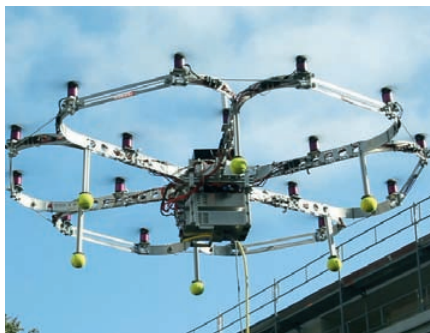
Der von Studierenden mitentwickelte elektrische Multikopter konnte an der Hochschule Karlsruhe erfolgreich einen einstündigen Testflug absolvieren. Foto: Prof. Jürgen Walter
