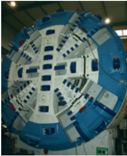
Eine Schildvortriebsmaschine (Ø: ca. 9 m) der Fa. Herrenknecht AG im Bau
