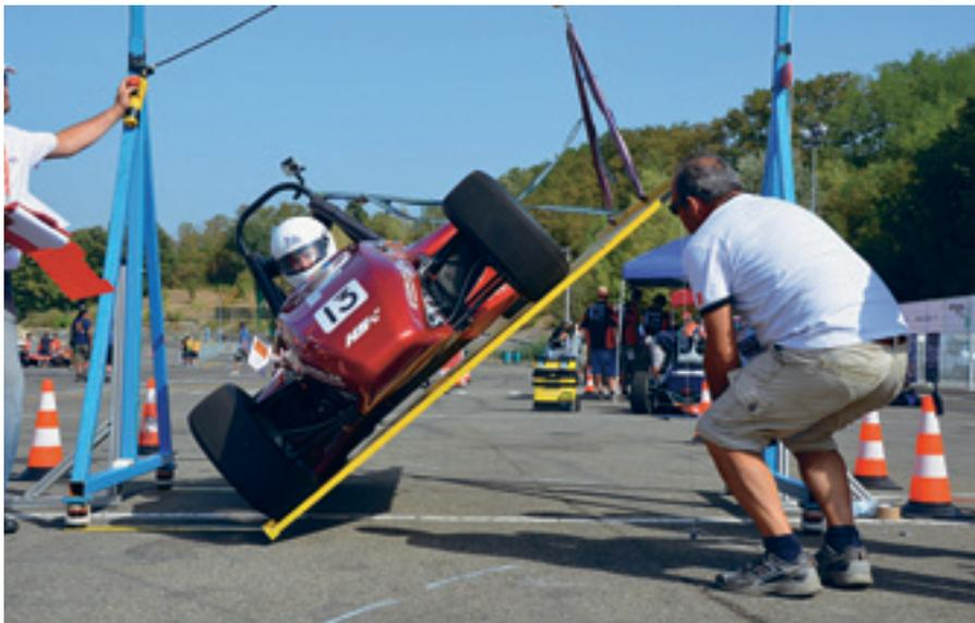
Der F-105 bei der technischen Abnahme auf dem Tilt Table (Kipptisch). Beim diesem Test wird überprüft, dass keine Betriebsflüssigkeiten wie z. B. Öl oder Benzin austreten. Die Fahrzeuge werden mit allen Flüssigkeiten und vollgetankt zu diesem Test gebracht und mit dem größten Fahrer besetzt. Das Fahrzeug wird bis zu einem Winkel von 60 Grad gekippt.
