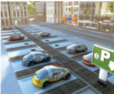
Simulation eines zukünftigen „e-Parkplatzes“. Hier werden Fahrzeuge induktiv – berührungslos, nur durch das Parken auf bestimmten Flächen – wieder aufgeladen. Copyright: Siemens AG
