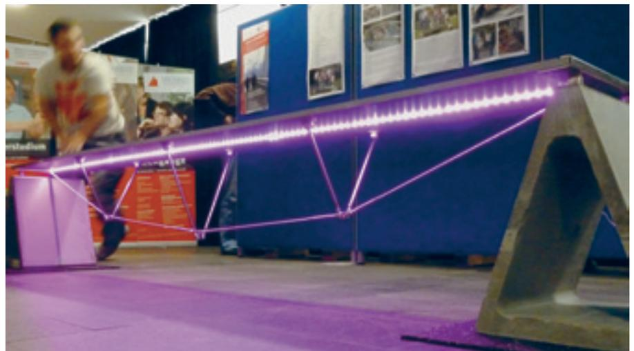
Brückengroßmodell mit mikrobewehrter, 18 mm starker Stahlbetonplatte am Regionaltag 2011
