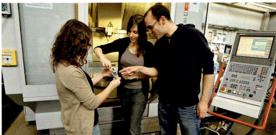
Felix Huying M. Sc. (r.), Akademischer Mitarbeiter am Institute of Materials and Processes, mit Studentinnen beim Zerspanungstests am institutseigenen 5-Achs-Fräszentrum Foto: John Christ
