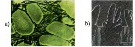
Mehrskalige Mikrostrukturen mit grobskaligen Primärdendriten und feinskaligem interdendritischem Eutektikum
