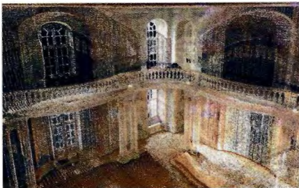
Asamsaal des Ettlinger Schlosses. Darstellung durch die Messpunkte des 3D-Laserscannings, koloriert mit den Farben des Digitalfotos.
