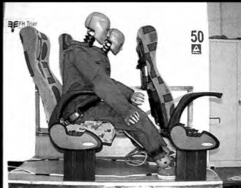
Oben: Vogel Sitze im dynamischen Versuch Unten: Analge für statische Zugversuche
