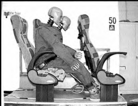
Oben: Vogel Sitze im dynamischen Versuch Unten: Anlage für statische Zugversuche
