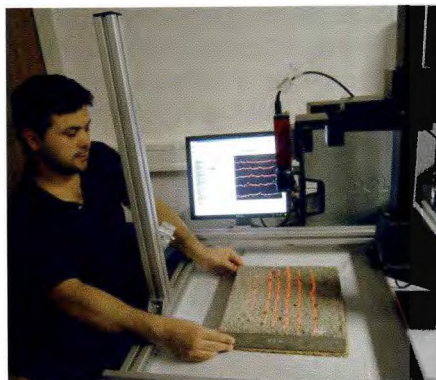
Entwicklung eines neuartigen Verfahrens zur Ermittlung der Oberflächenrauigkeit von sandgestrahlten Betonoberflächen mit Hilfe der Lasertriangulation (Masterthesis)
