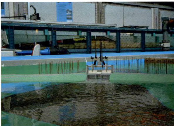
Modelluntersuchungen (Auslassbauwerk; überströmbarer Querdamm)
