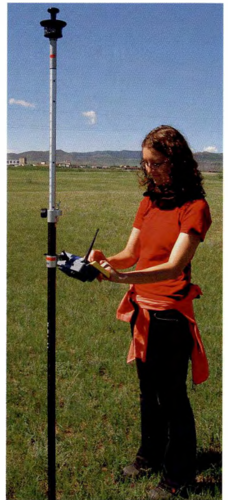
Juliane Kollowa mit Kontrolleinheit am Reflektorstab beim Aufnehmen von Geländepunkten
