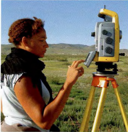
Messung mit Kontrolleinheit an der Robotikstation
