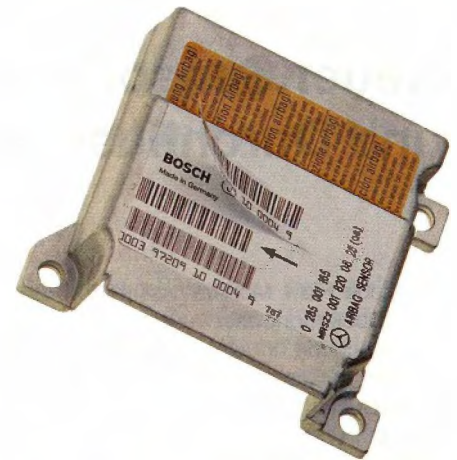
Basis- und Teiletiketten ermöglichen die komplette Rückverfolgung der Produktionsschritte
