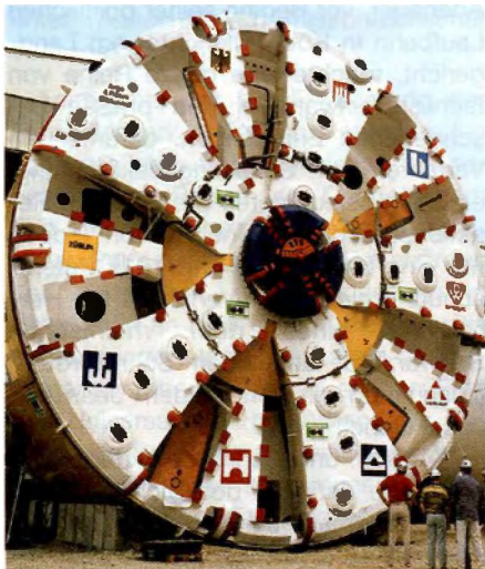
Bis dato größte Tunnelvortriebsmaschine der Welt mit einem Durchmesser von 14.200 mm
