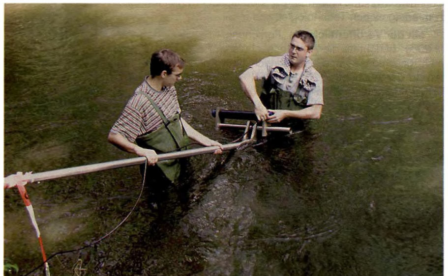
Einbau einer Messsonde aus dem Projekt „Mobile Pegelanlage“ (Prof. Dr.-Ing. Norbert Eisenhauer)
