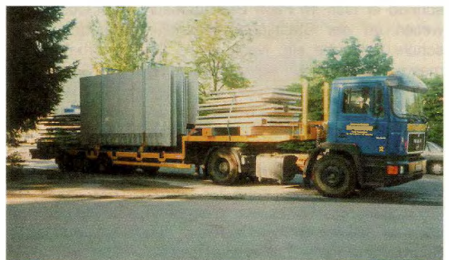
LKW mit Fertigbetonteilen
