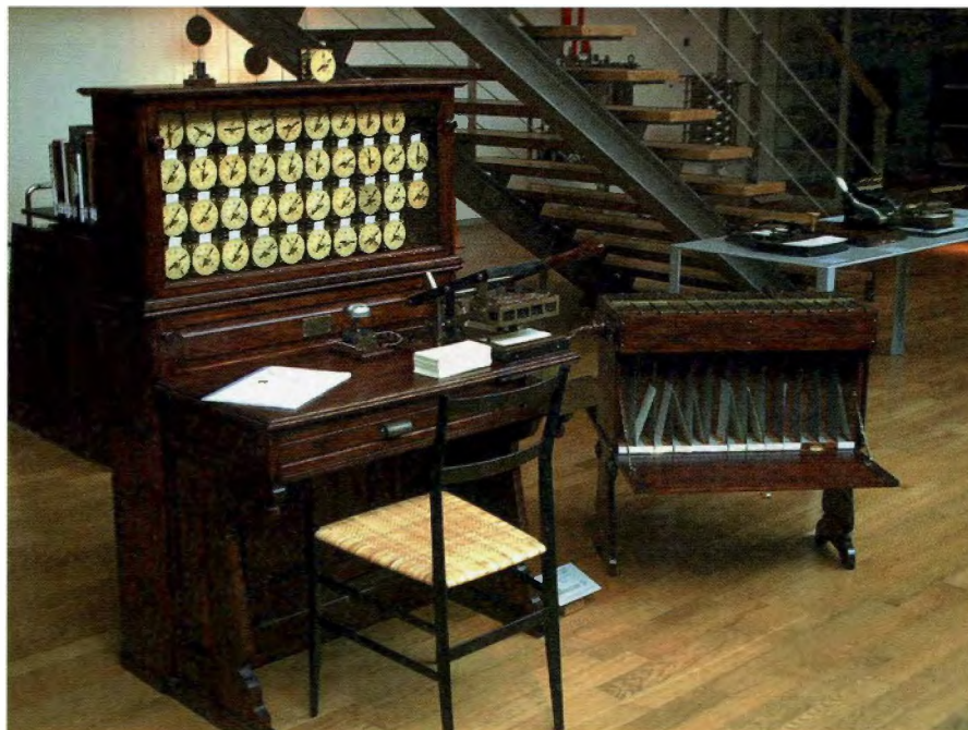
Hollerith-Rechenmaschine, die bei der Volkszählung in den USA 1890 eingesetzt wurde
