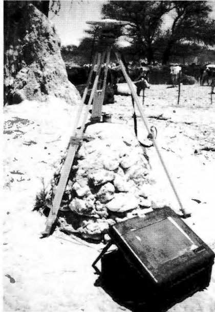
NAM98-Verdichtungsmessung auf klassischem TP des alten namibischen Netzes
