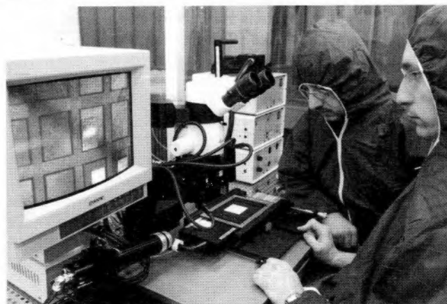
Nicht Millimeter-, sondern Mikrometer Arbeit: ein Halbleiter wird mit den Leiterbahnen des \text{Al}_2\text{O}_3 -Substrats verbunden
