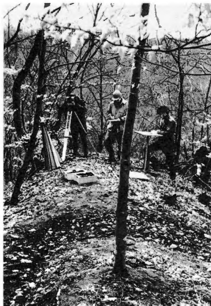
Studenten des Studiengangs Vermessungswesen bei der topographischen Aufnahme eines Walls mit modernem elektronischen Tachymeter
