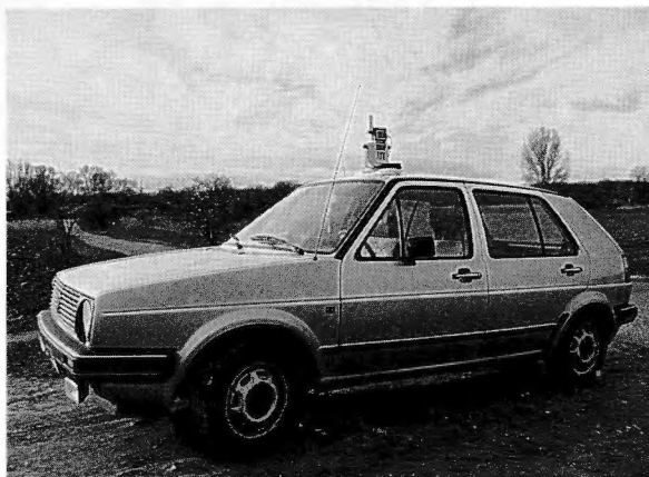
Kinematische Vermessung mit Magellan
