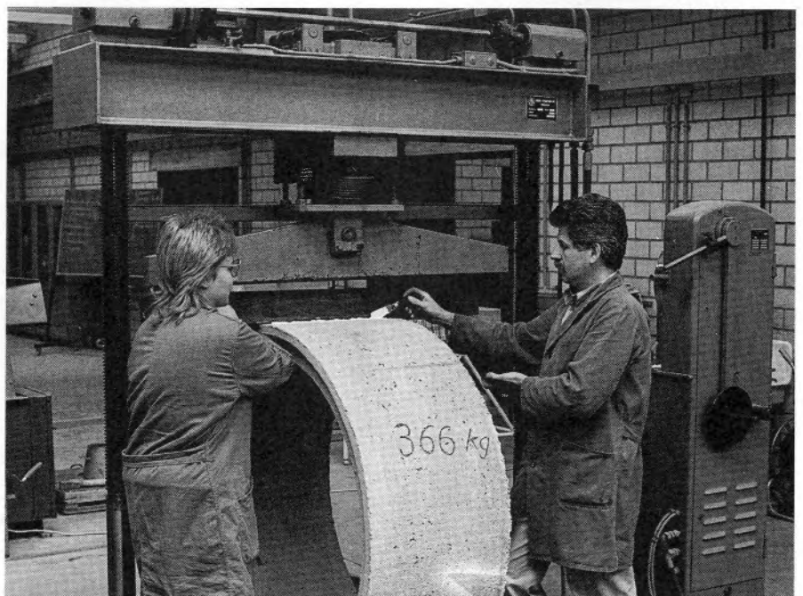
Einbau eines Entwässerungsteils aus Beton in die Prüfmaschine
