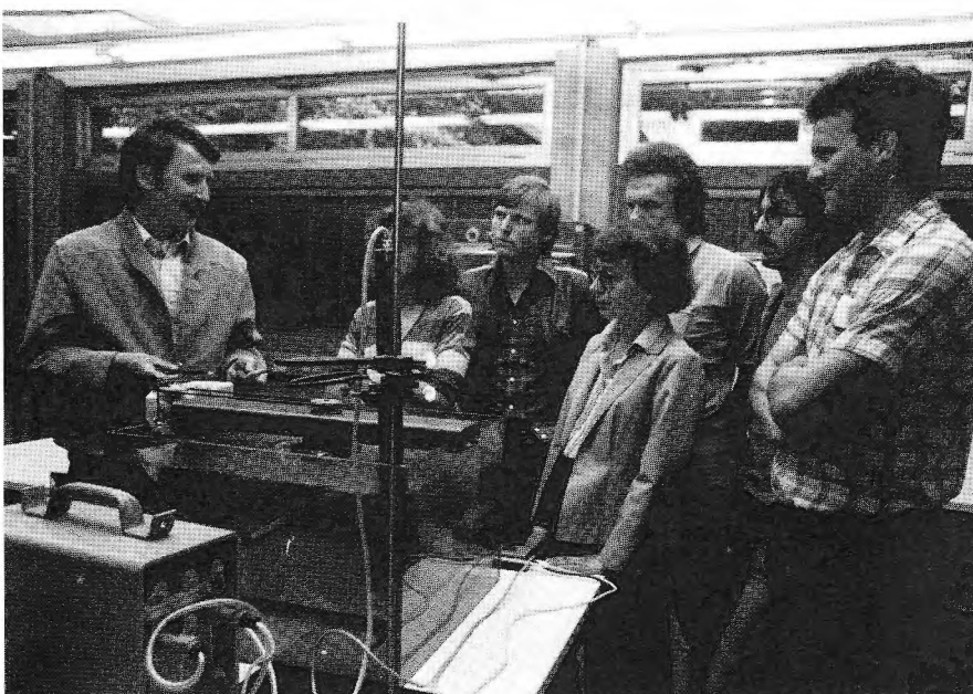
Studenten des Bauingenieurwesens bei der Messung des Sauerstoffeintrages einer Belüftungseinrichtung in eine klärtechnische Einrichtung. Foto: Zimmermann
