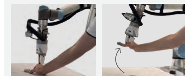
Abb. 2: a) Übersicht des Lernverfahrens zur visuellen Regelung; b): Beispielprozess, der Roboterarm UR5e richtet sich orthogonal in einem Abstand von 25 cm zum Bauteil aus
