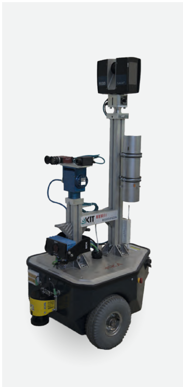
Die Umwelterfassungsplattform GammaBot (Foto: Dennis Hartmann)
