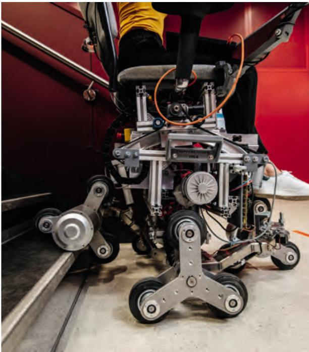
Abb. 3: Treppensteiger-Prototyp mit vier rautenförmig angeordneten Sternrädern (Foto: Andreas Reeg)
