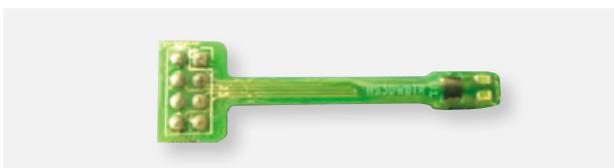
Abb. 3: Messaufbau zur Detektion von flüssigem Kältemittel in der Saugleitung eines Kältemittelverdichters mittels MEMS-Beschleunigungssensor, angebracht auf einem Miniatur-Biegebalken in der Strömung
