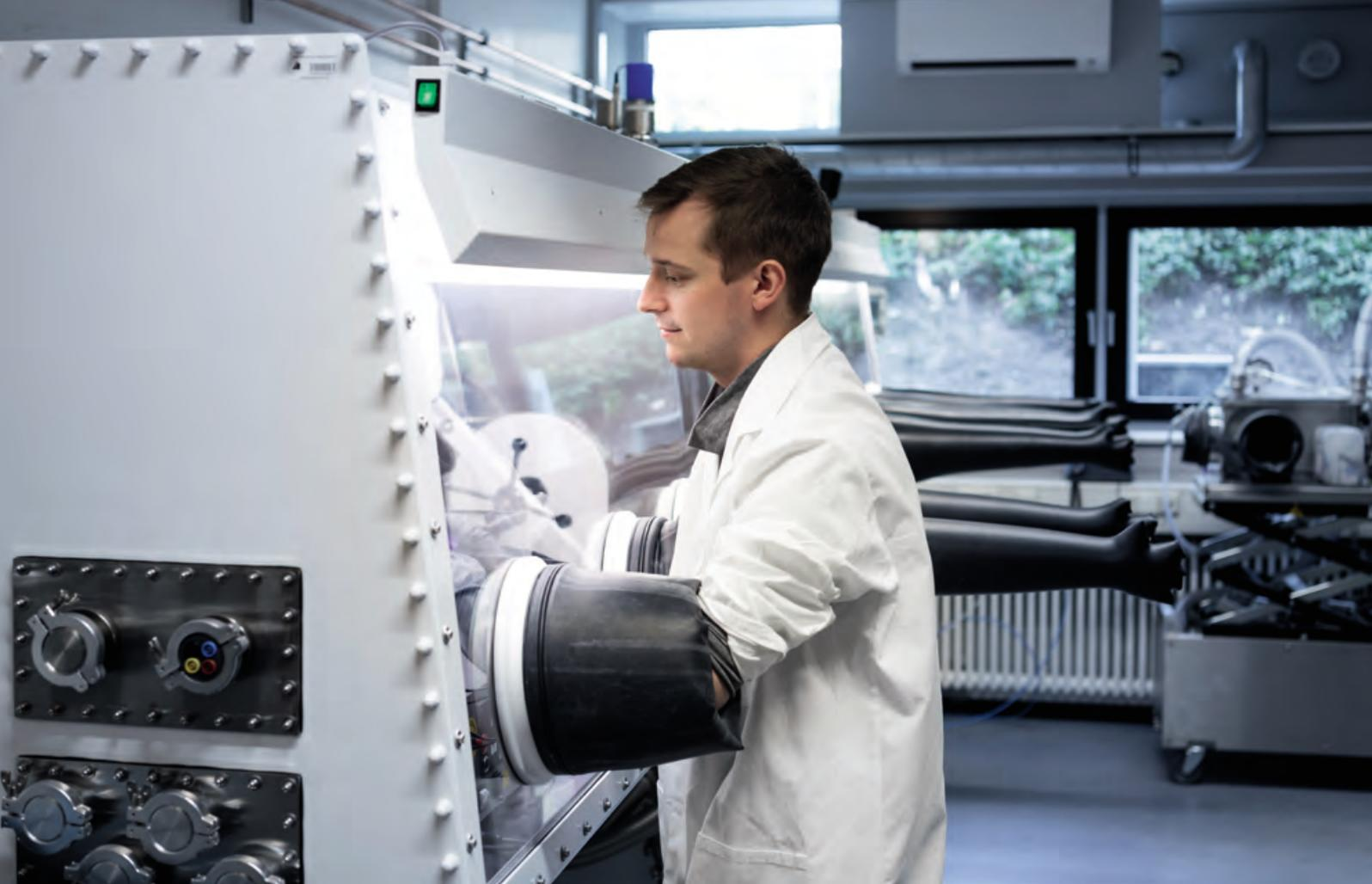
Im Labor für Lithium-Ionen-Batterien an der HKA: Der Zellaufbau erfolgt in mit Argon gefüllten Gloveboxen (Foto: Tobias Schwerdt)
