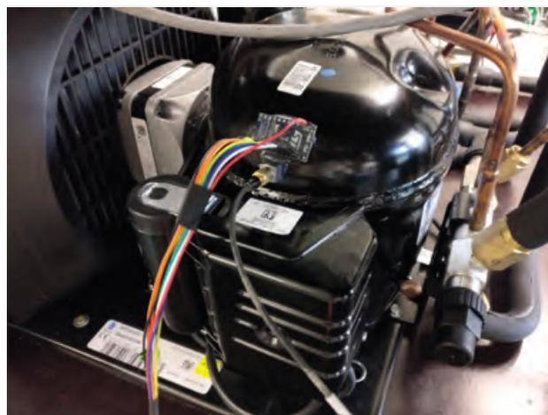
Abb. 1: Untersuchungen der Gehäusevibrationen mit einem MEMS-Beschleunigungssensor und vergleichend mit einem industriellen piezoelektrischen Beschleunigungssensor auf einem hermetischen Verdichter kleinerer Kälteleistung (Foto: Franz Joseph Pal)
