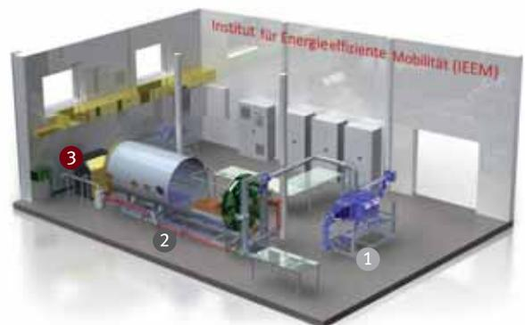
Abb. 1: Anlagenschema des Klima- und Höhensimulationsprüfstands und Umsetzung in den Laborräumen des Instituts für Energieeffiziente Mobilität (IEEM)
