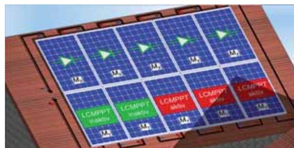
Abb.1: PV-Strang aus 10 PV-Modulen in Reihe auf einem Einfamilienhaus. Module  $M_x$  ohne Verschattungspotenzial sind zum Schutz mit Bypass-Dioden ausgerüstet. Bei temporär verschatteten Modulen  $M_y$  betreibt der LCMPPT die Module individuell am MPP. Ohne Schatten verursacht der inaktive LCMPPT im Vergleich zur Bypass-Diode minimale Verluste
