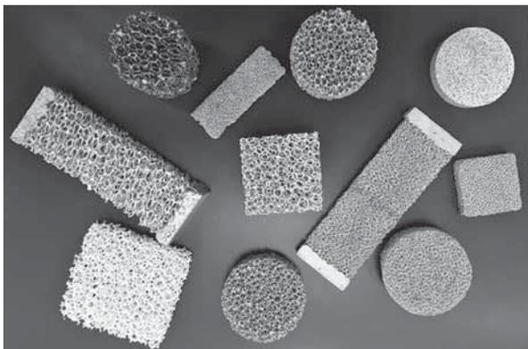
Abb. 1: Metallschäume (Foto: TinniT Technologies GmbH)
