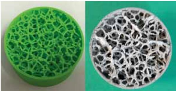
Abb 2: Ausdruck einer synthetischen Schaumstruktur; 3D-Druck Platzhaltermodell (links) sowie Abguss der Struktur in Aluminium (rechts); der Abguss wurde von dem FuE-Kooperationspartner Hochschule Pforzheim in der Arbeitsgruppe „Metallische Schäume“, geleitet von Dr.-Ing. A. Matz, angefertigt (Foto: IMP, HsKA)
