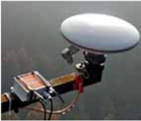
Abb. 3: MEMS-Box und GNSS-Antenne installiert oberhalb der Aussichtsplattform in ca. 154 m Höhe
