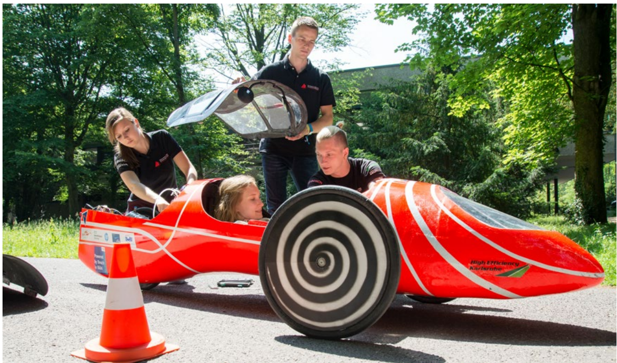
Mit ihrem selbst konstruierten und gebauten Fahrzeug „Nemo“ waren die HsKA-Studierenden in London sehr erfolgreich und konnten mit nur einem Liter Benzin 579,2 Kilometer zurücklegen – das entspricht einem Verbrauch von ca. 0,17 Litern auf 100 km (Foto: Dominik Störkle)
