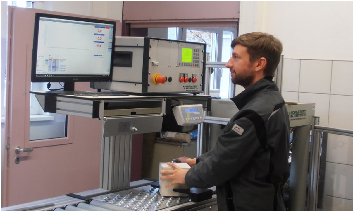
Vermessen eines Betonwürfels an der ÖBP
