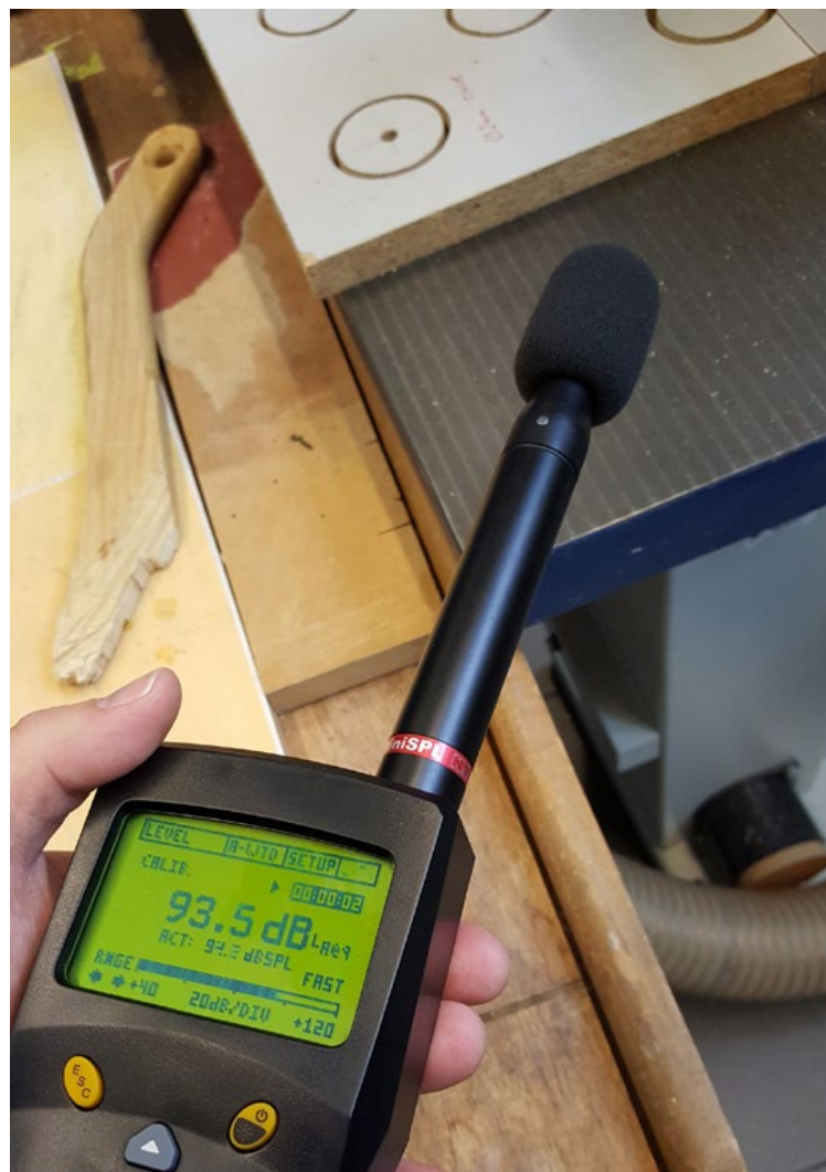
Messung des Lärmpegels mit in diesem Fall zu hohem Wert (Foto: Andreas Erdmann)
