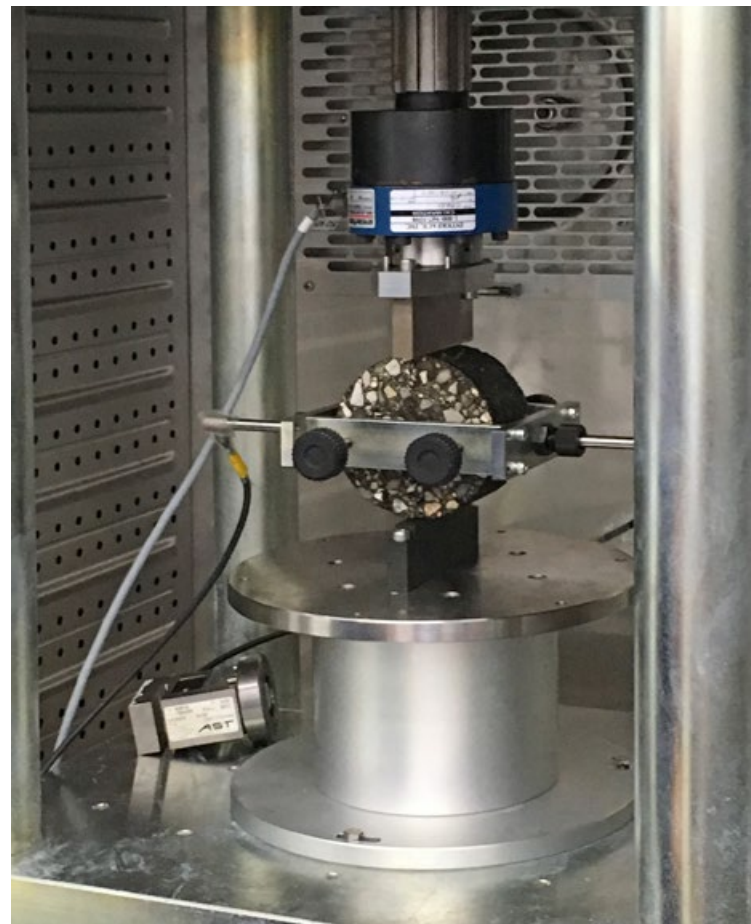
Prüfung eines Bohrkerns mit einer dynamischen Prüfpresse (Foto: Markus Stöckner)
