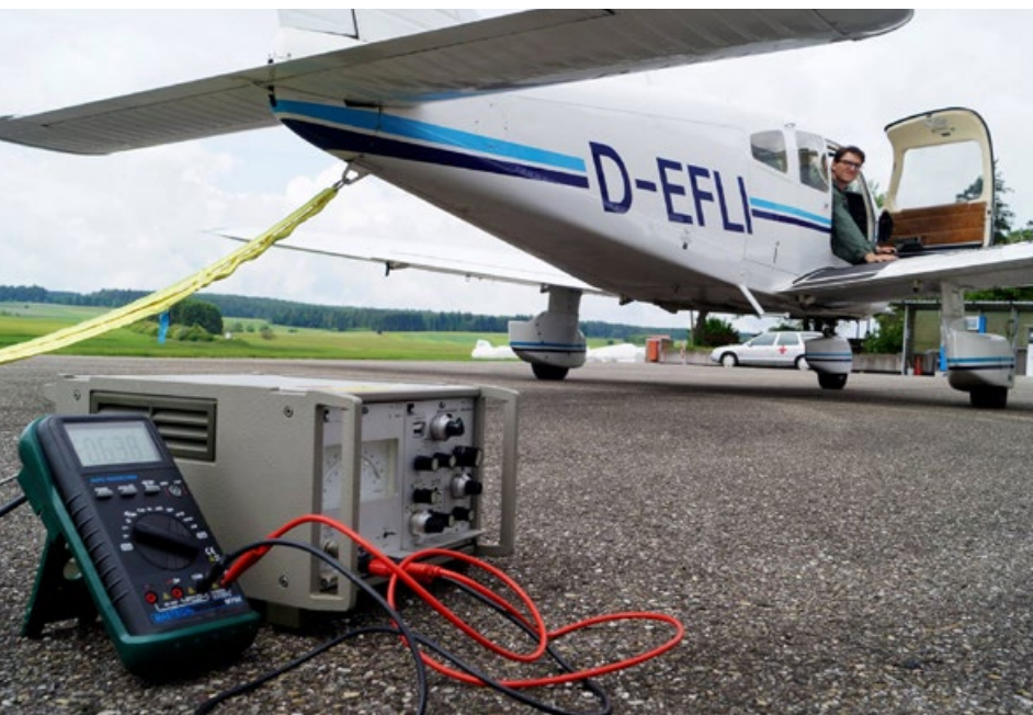
Lum Sulejmani aus dem 6. Semester des Bachelorstudiengangs Maschinenbau bei der Messung des Standschubs einer viersitzigen Piper PA-28 während des Fluglabors (Foto: Daniel Krail)
