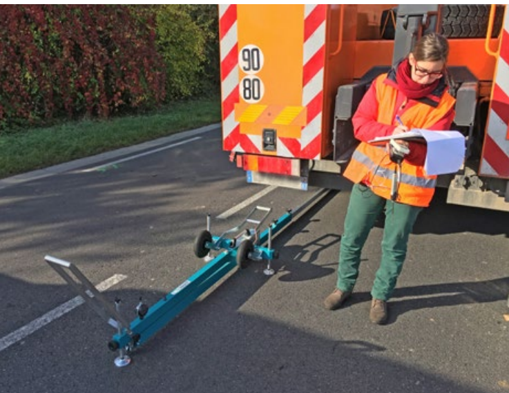
Doktorandin Loba Sagnol bei der Messung von Tragfähigkeiten verschiedener Straßenaufbauten einer Regionalstraße in der Nähe von Colmar (Foto: Markus Stöckner)
