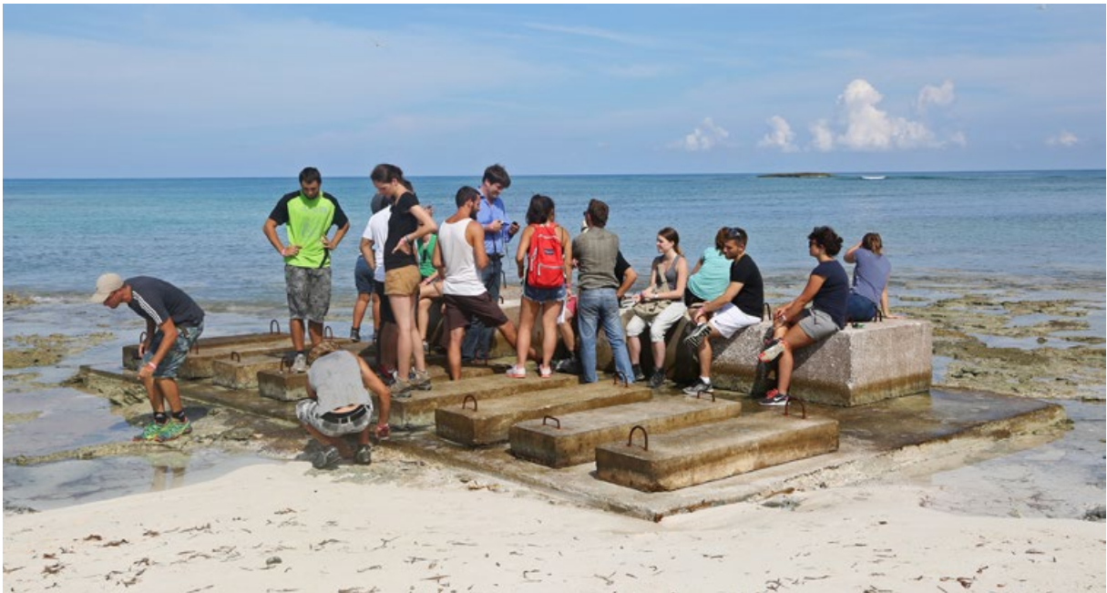
Studierende untersuchen Betonklötze auf ihr Verhalten in salzhaltiger Luft bzw. Salzwasser
