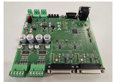
PCB der Motorsteuerung für 2 Motoren
