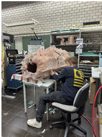
„Einpacken“ des Monocoques für das Aushärten unter Temperatur und Vakuum im Autoklaven
