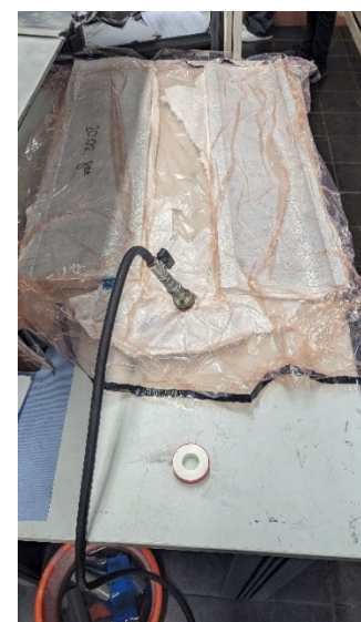
Sandwich aus Carbon und Schaumstoff im Vakuumsack, der die Lagen in die Form presst
