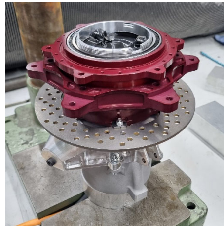
Das komplette Antriebsrad Elektromotor, Wasserkühlung, Bremsscheibe, Radträger, Getriebe und Felgenaufnahme
