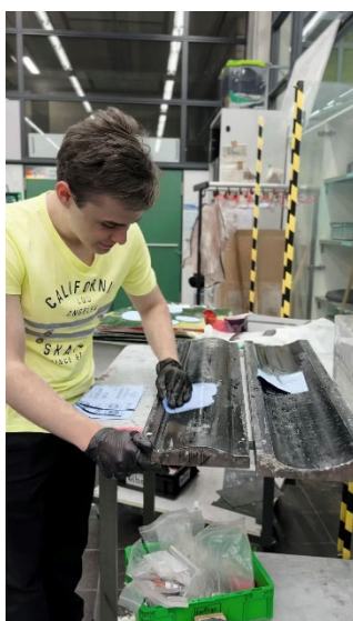
Vorbereiten der Formen für das Laminieren der Carbonmatten
