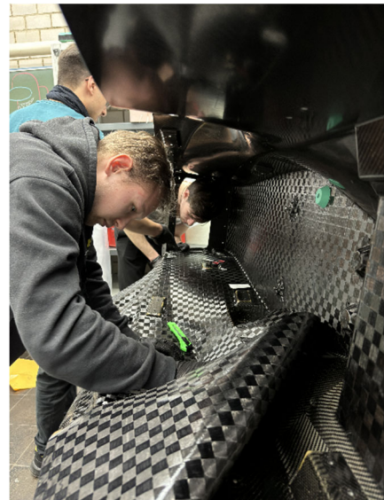
Einlegen der Carbonmatten in die Carbonform
