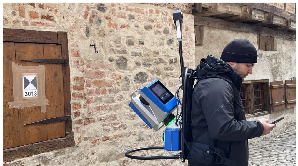
**Laserscanaufnahme mit dem Z+F FlexScan® 22**
