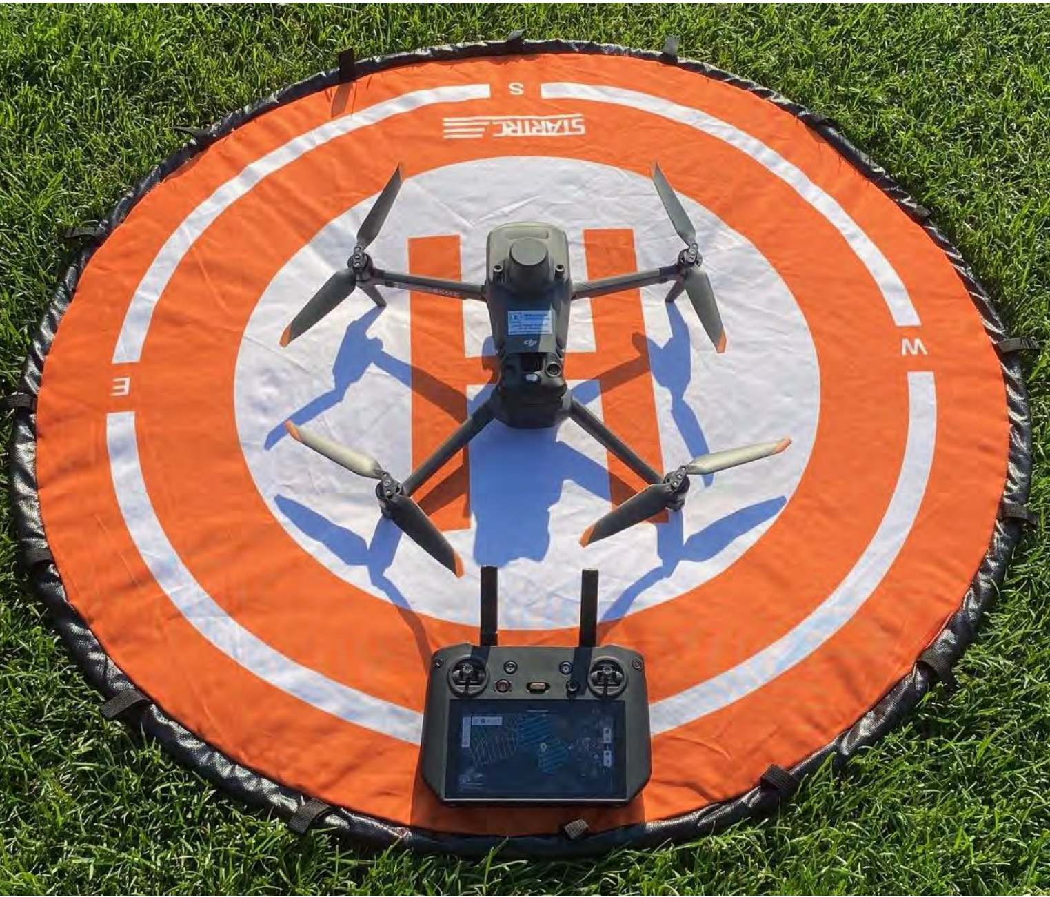
Abb. 1: DJI Mavic 3M Drohne mit DJI RC Pro Fernbedienung und dem Landepad auf dem Golfplatz
