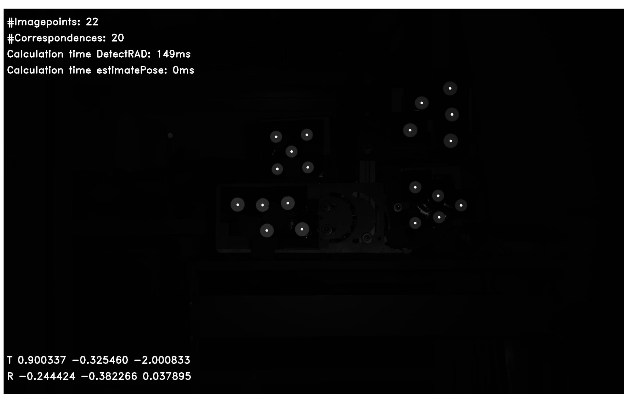
Ausgabe nach Auswertung: Ergebnis der Marker-Detektion, Korrespondenzanalyse und Pose-Schätzung.
