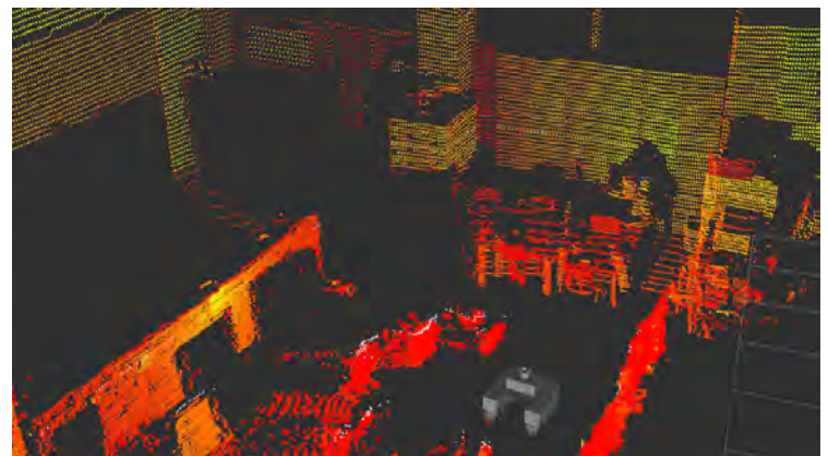
Pointcloud des auf dem Harby angebrachten Lidar – Raum B-219
