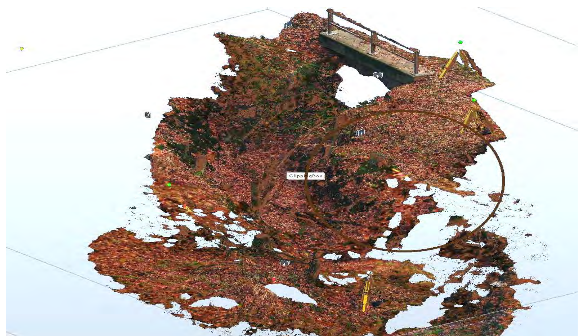
Abb. 3: Digitales Geländemodell des Grabenabschnittes (Vegetation aus Punktwolke herausgeschnitten)
