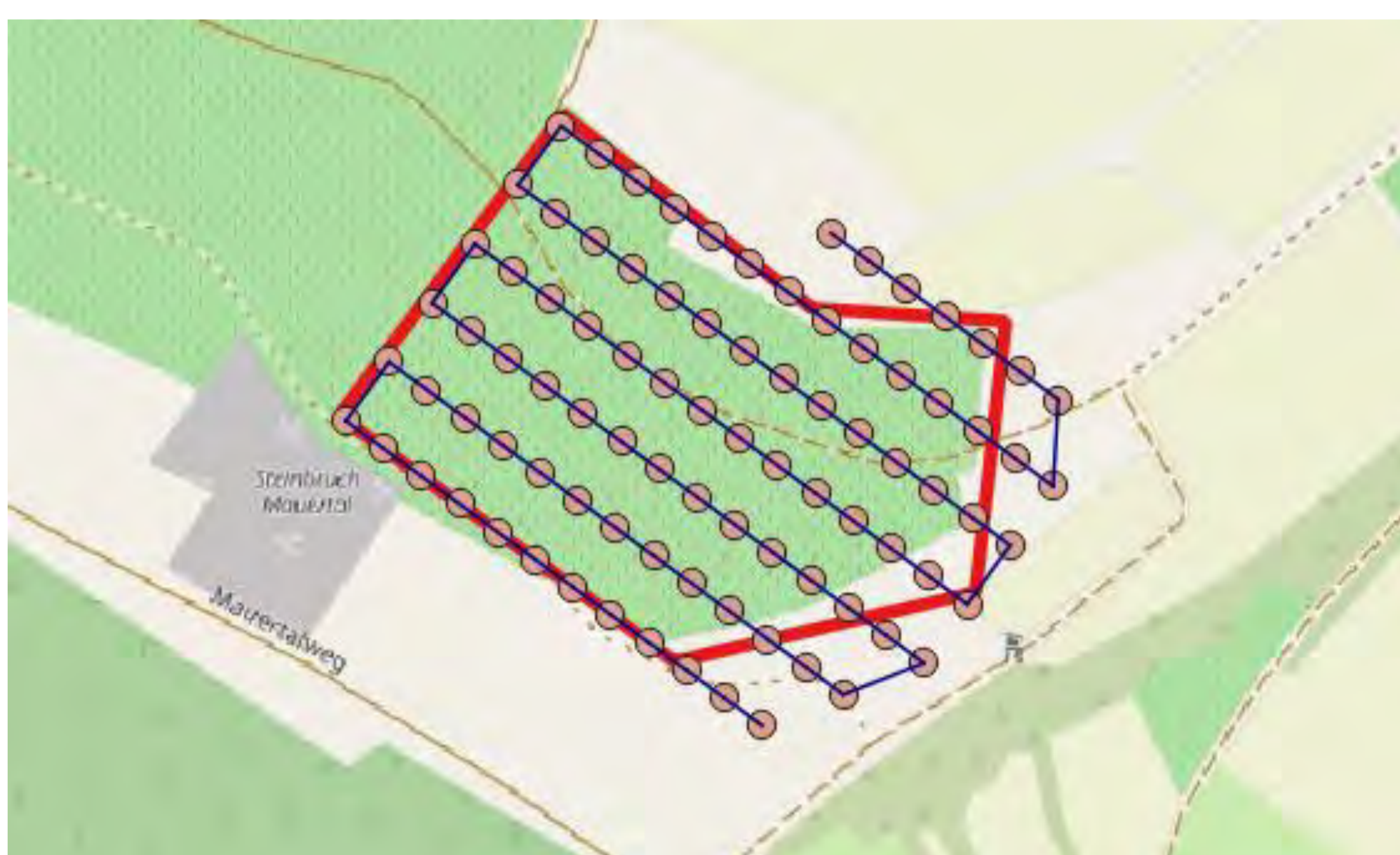
Ergebnis einer Flugplanung in QGIS für einen definierten Bereich
