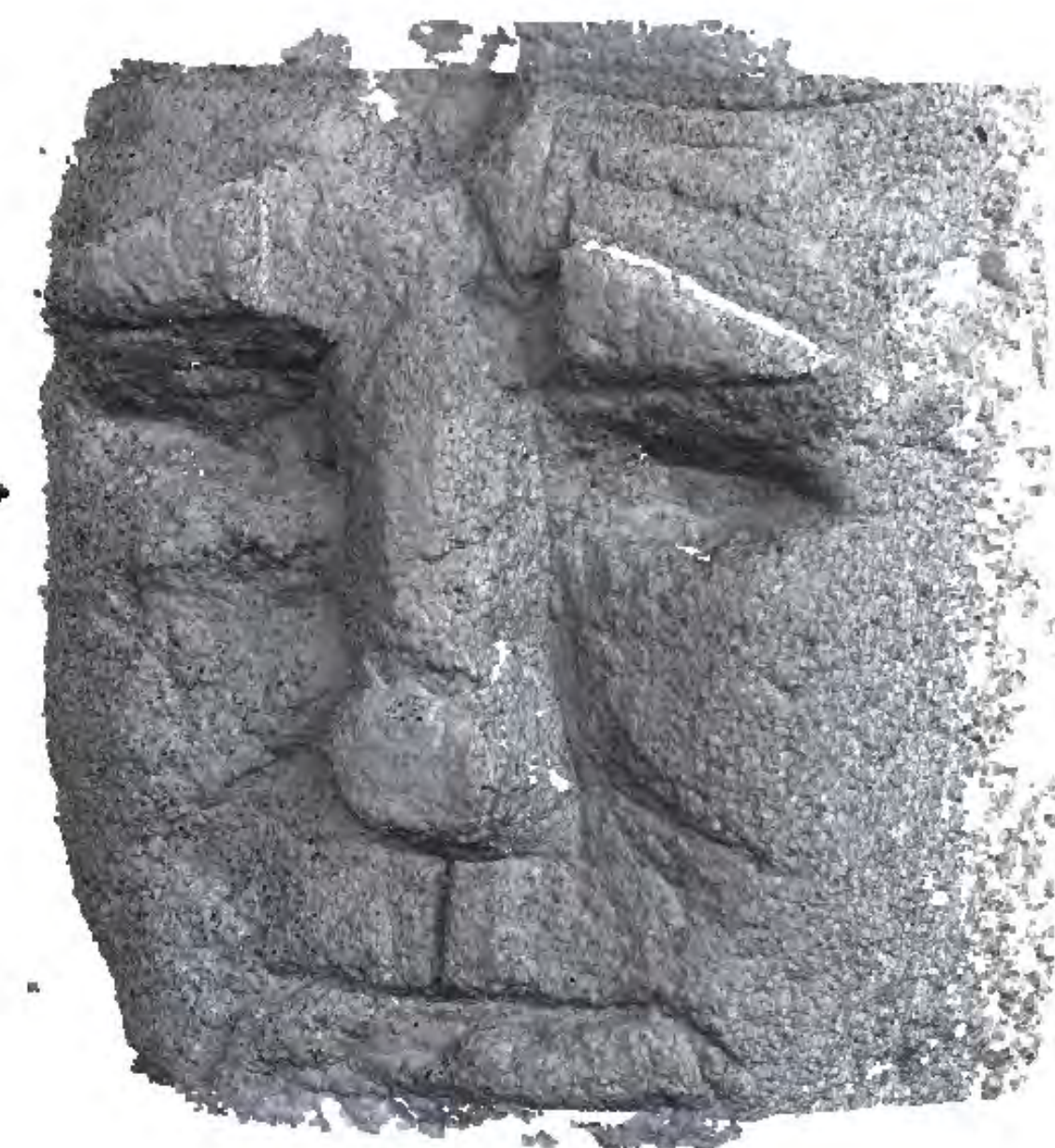
Dense Cloud einer Statue berechnet in Metashape mit importierter innerer und äußerer Orientierung
