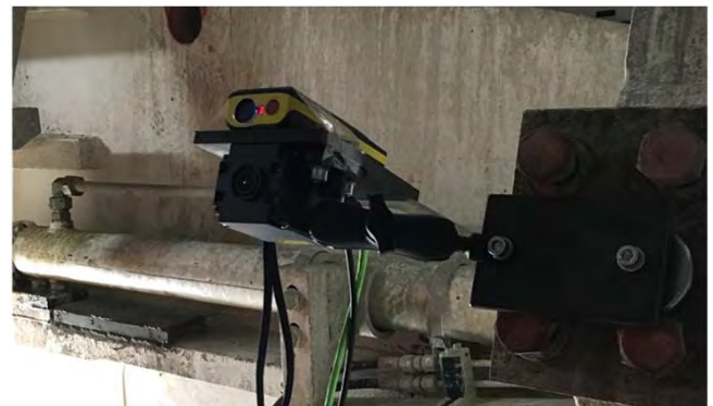
ToF-Kamera mit Disto auf einer Tunnelbaustelle
