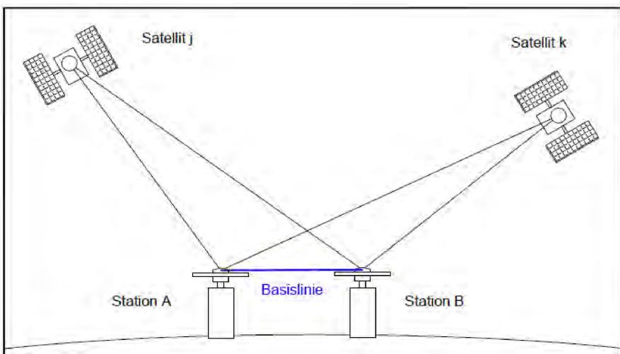
Abb. 1 Basislinie zwischen zwei Empfängern
