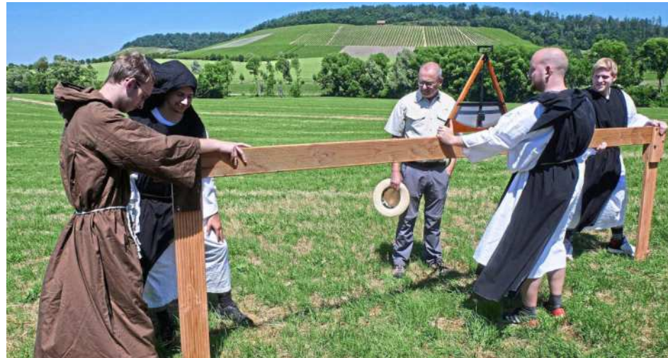
Mit einem Chorobat, einem Messinstrument aus Setzlatte und Setzwaage, ermitteln Studenten mit Heinz Saler (Mitte) das Gefälle eines früheren Wassergrabens. Foto: Stefan Friedrich
