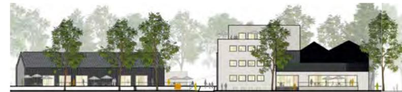
Die Idee des Entwurf ist verblüffend einfach: In einer Leichtkonstruktion wird auf dem eingeschossigen Baukörper des Mühlengebäudes ein zusätzlicher, vielfältig beispiel- und veränderbarer Raum platziert. Der Raum erhält, entsprechend der umliegenden Häuser des Wohngebiets, zwei Satteldächer, die nach innen hin ein interessantes Raumgefühl schaffen und die Möglichkeit geben, durch Oberlichter einen gut beleuchteten und nach innen orientierten, konzentrierten Arbeitsraum zu schaffen.
